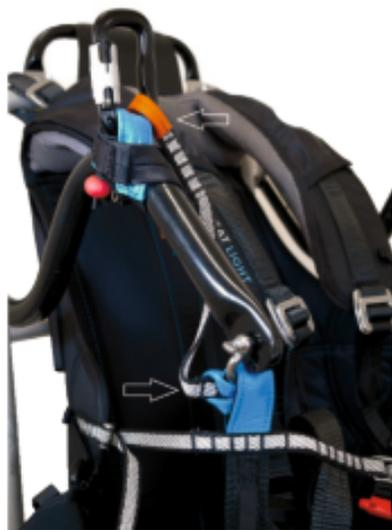
Befestige vor der Installation eines Rettungsschirmes im seitlichen Container die V-Leine mit Hilfe einer Verbindungsleine (Verbindungsgurtes). Benutze O-Ringe um die Leine/den Gurt auf den (Metall)Quicklinks (Maillon Rapide C6 oder C7) gegen Verrutschen zu sichern.
