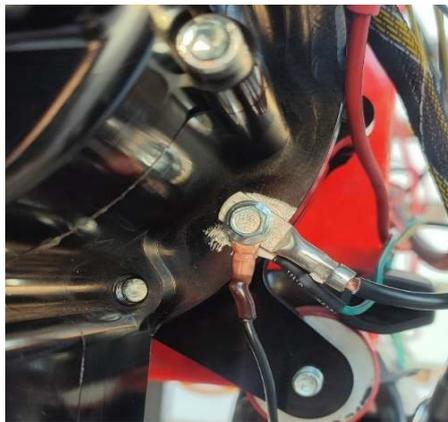
Wir empfehlen mindestens 6mm<sup>2</sup> Kabel besser 8mm<sup>2</sup> für die Verbindung zum Starter und von Batterie Minus zum Massepunkt.
