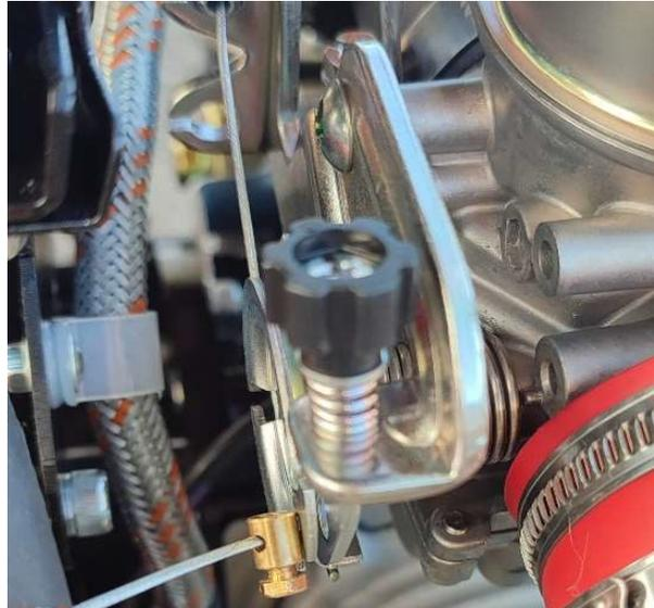
Die Leerlaufdrehzahl wird durch Drehen der kleinen schwarzen Schraube an der Seite des Drosselklappenquadranten eingestellt, wie in der Abbildung gezeigt.
