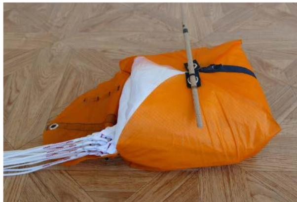
16. Beginnend beim Haupttragegurt schieße das Leinenbündel in Form einer „8“ auf. Verwende Gummiringe auf Silikonbasis zur Befestigung der Leinenbündel.
